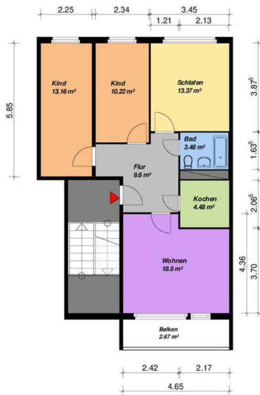
4-Raum -WE - WBS-70-Typ C1-rechts-mit Balkon
