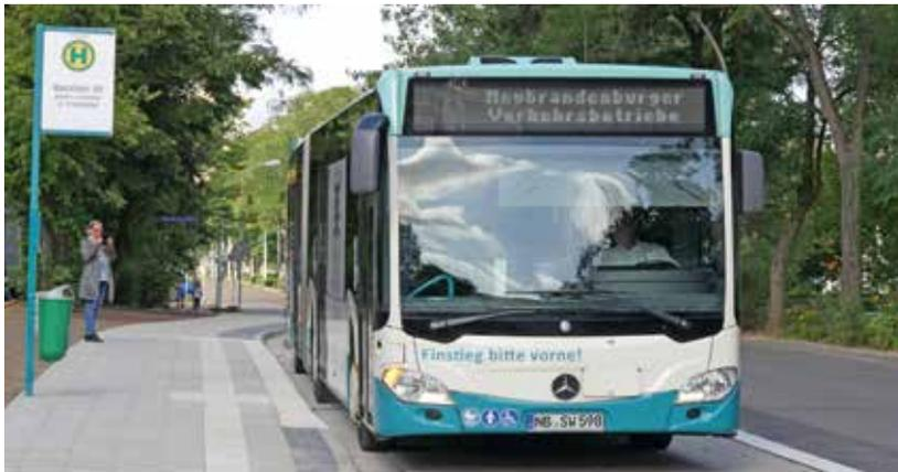
vom Einstiegsbereich zu unterscheiden. Sogenannte Kasseler Borde ermöglichen das Absenken der Niederflurbusse und einen bequemen Einstieg.
